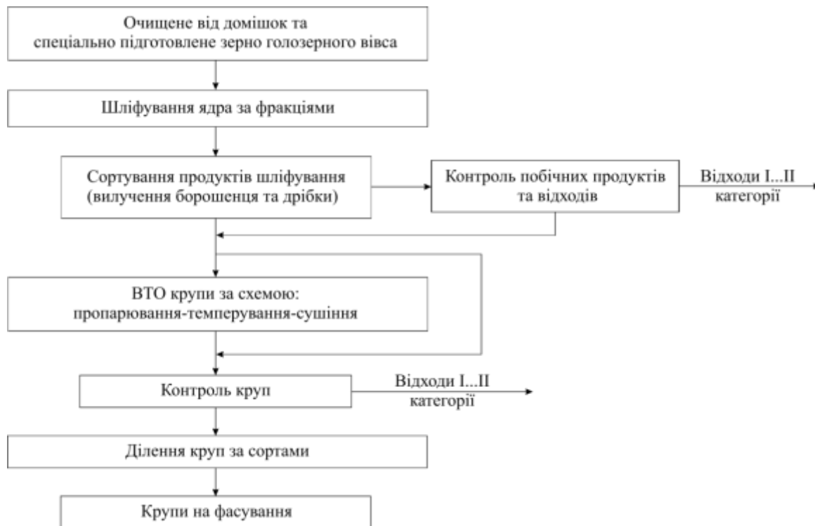
Рис. 1 – Структурна схема переробки голозерного вівса в крупи типу неподрібнених
