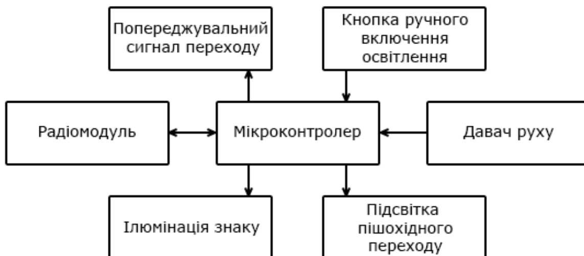
Рис. 1. Структурна схема знака “Пішохідний перехід”
