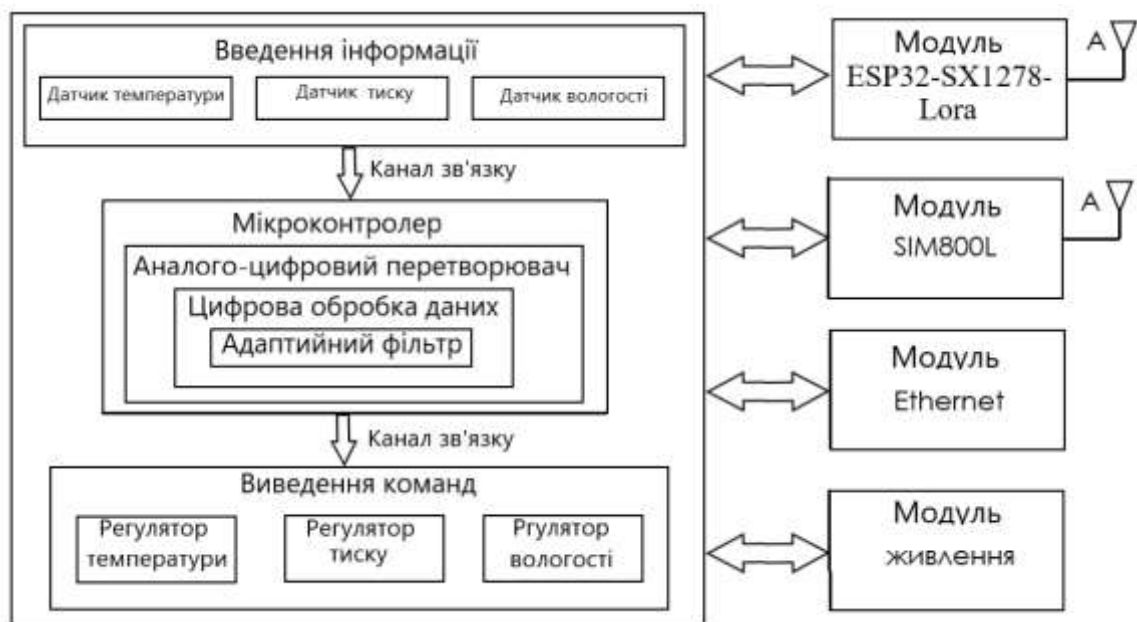
Рис.1. Структурна схема контролера для вимірювання і регулювання кліматичних умов
