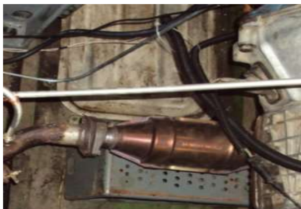
Рисунок 4 - Компонування трикомпонентного каталітичного нейтралізатора в системі випуску ВГ (вид зверху)
